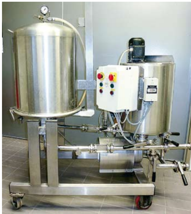
>> PORTABLER ANSCHWEMMFILTER FÜR kleine und mittlere Weingüter
