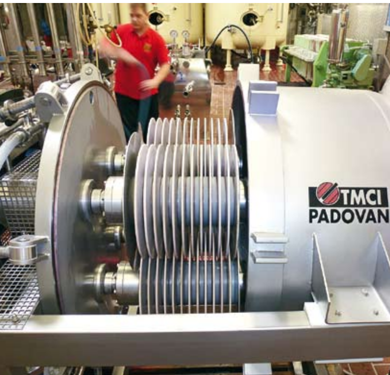
>> MODULBLÖCKE MIT KERAMIKMODULEN, die mit bis zu 300 U/min rotieren und so für die Überströmung sorgen
