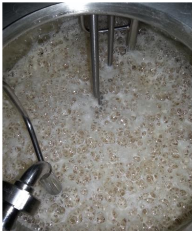
Abbildung 3: Blick in eine Submersanlage
