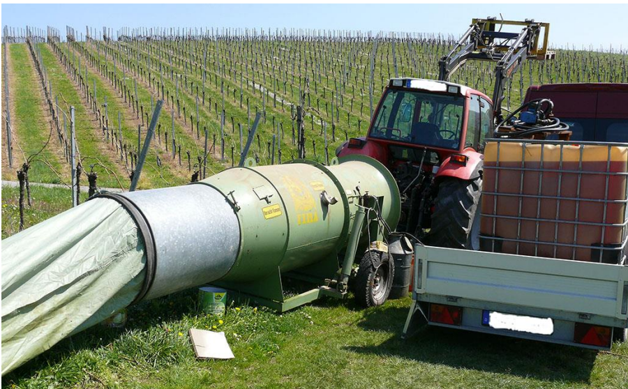
Über Schlauchsysteme oder Gebläse wird den Reben aktiv Wärme zugeführt
