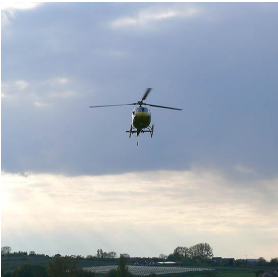
Bei Inversionswetterlagen kann ein Hubschrauber über seinen Rotor wärmere Höhenluft mit der kälteren am Boden durchmischen
