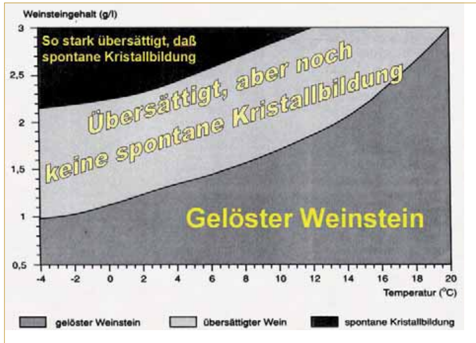
Abb. 4: Löslichkeit von echtem Weinstein (KHT) sowie den Bereichen mit Übersättigung an KHT (verzögerte Kristallisation) und extremer Übersättigung (spontane Kristallbildung) (JAKOB L, HAMATSCHEK J und andere, 1997)
