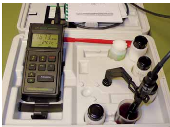
Abb. 6: Krista-Test-Konduktometer zur Bestimmung der Weinsteinsättigungstemperatur
