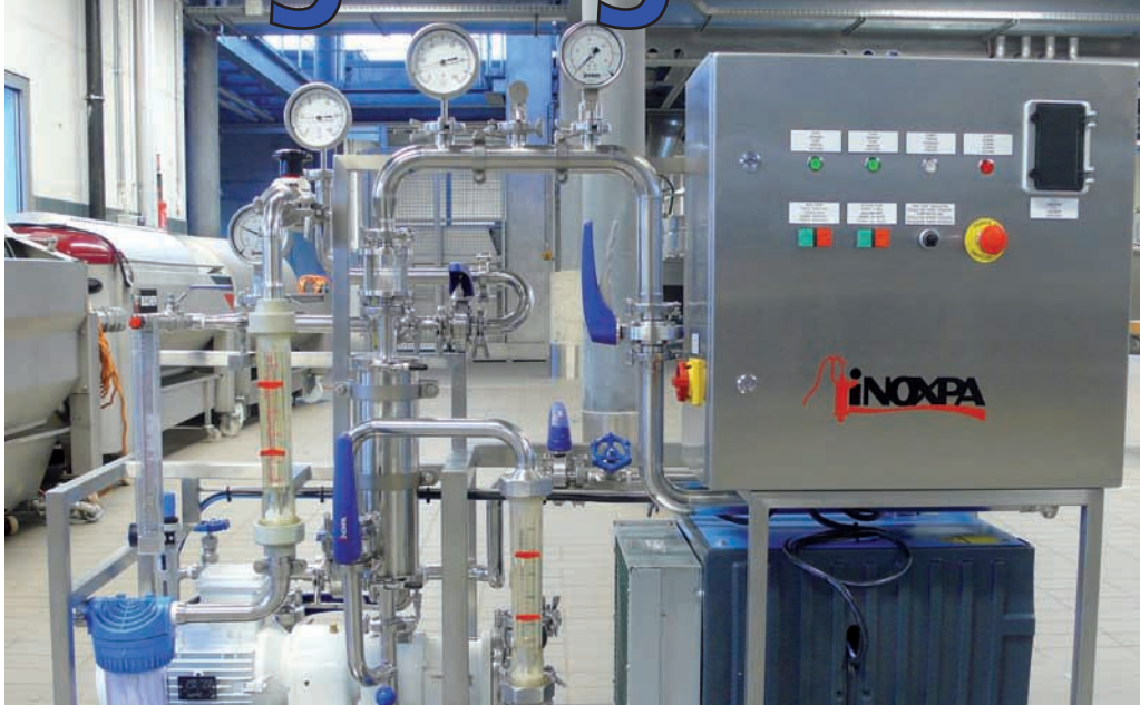
Anlage „WineBran“ mit einer Stundenleistung von 2 500 l.
