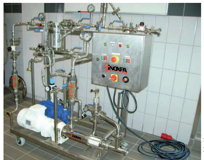
Abb. 5: Pilotanlage der WineBrane mit einer Stundenleistung von bis zu 400 l/h.
