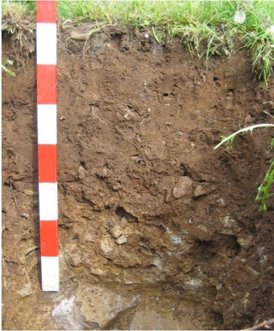
Abb. 4: Bodenprofil im Lauffener Gewann Jungfer: bei 70 cm ist der glattgeschliffene Muschelkalk des ehemaligen Flussbetts zu erkennen
