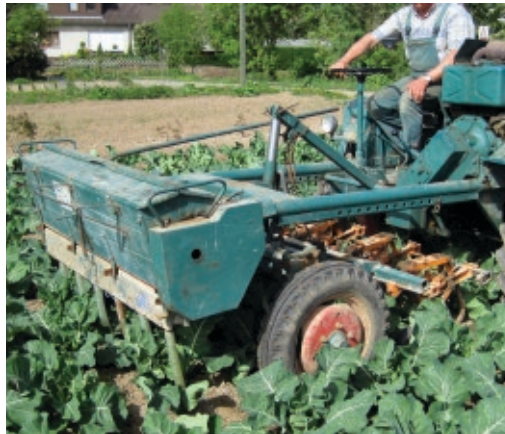
Bild 2 (li.) Teilautomatisierte Bodenprobenahme in einem Begrünungsbestand
