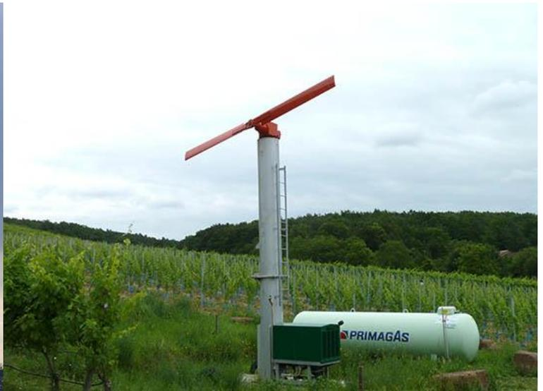
Ein Windrad verwirbelt wärmere Luft aus der Höhe mit der kälteren Luft am Boden
