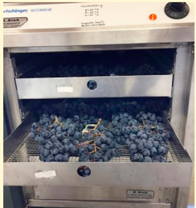
Abb. 2: Trocknung von Trauben im Dörrautomat
