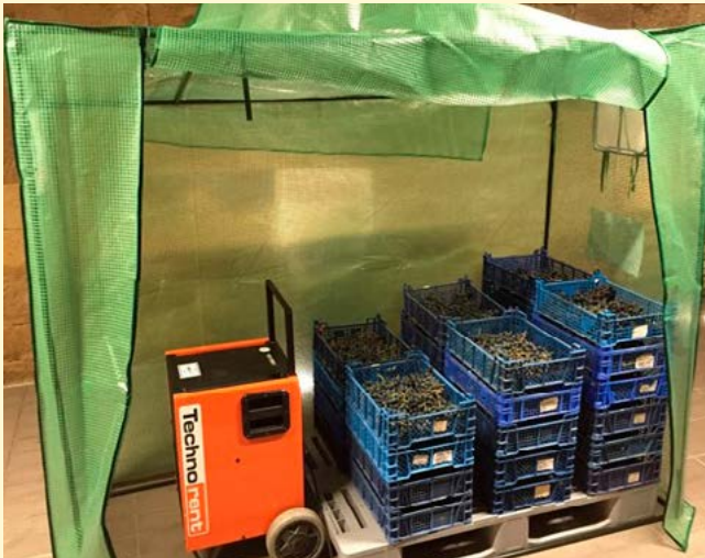
Abb. 3: Traubentrocknung im Pilotmaßstab
